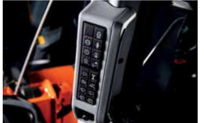
Yaygın olarak kullanılan tüm fonksiyonlar, yan panel düğmesi ile bir bakışta seçilebilir.
