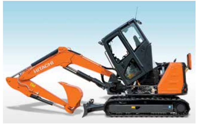
Katlanabilir kabin, hızlı servis için motora ve kontrol valfine kolay erişim sağlar.
