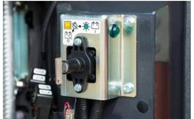
Akü bağlantı kesme anahtarı, bakımın güvenli bir şekilde yapılmasını sağlar.
