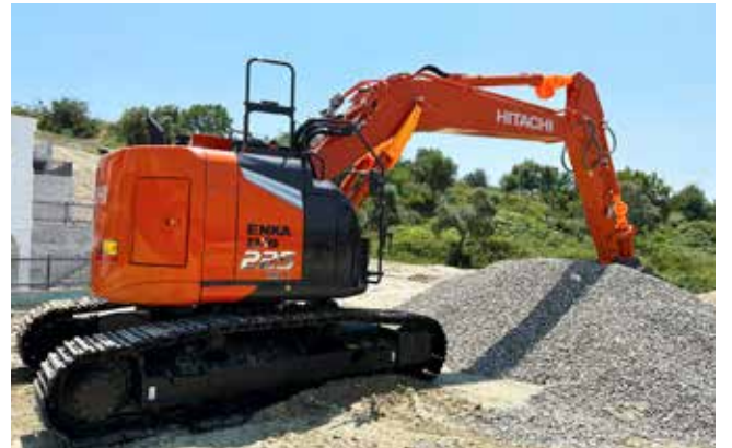
ZX225USLC-7'nin ultra kısa dönüş yançapı ile dar alanlarda ideal bir kullanım sağlar.
