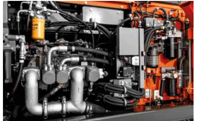
TRIAS III hidrolik sistemi ile %11'e kadar yakıt tasarrufu sağlanır.
